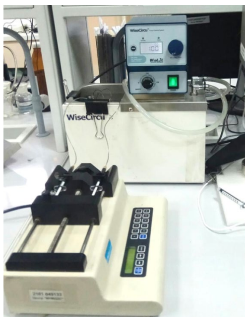
Рис. 2.24. Экспериментальная установка для определения влияния ВЧ и СВЧ ЭМ методов воздействий на интенсивность образования отложений
