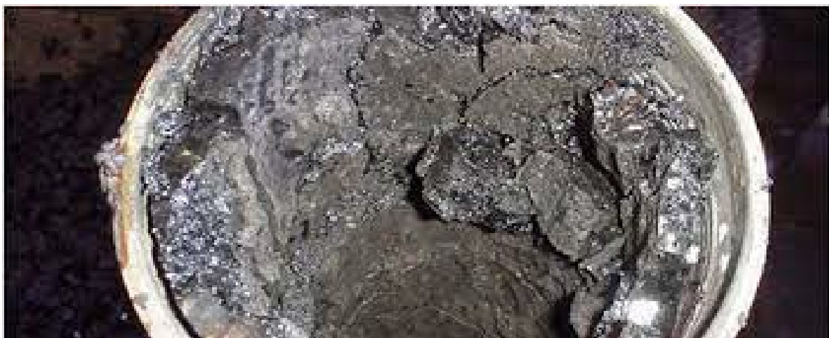
Рис. 2.22 – Отложения на стенках нефтепровода
