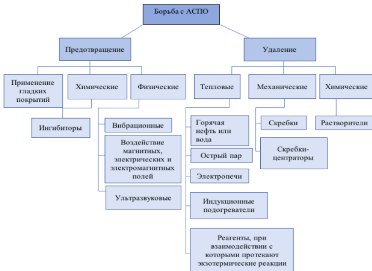
Рис. 2.23 . Методы борьбы с АСПО на внутренних стенках нефтепроводов
