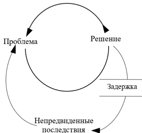
Рисунок 2.18 – Графическая модель, соответствующая архетипу «Симптоматические решения»
