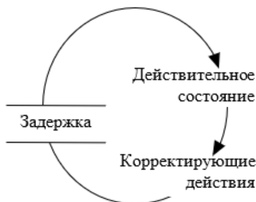
Рисунок 2.11 – Графическая модель, соответствующая архетипу «Задержка действий»
