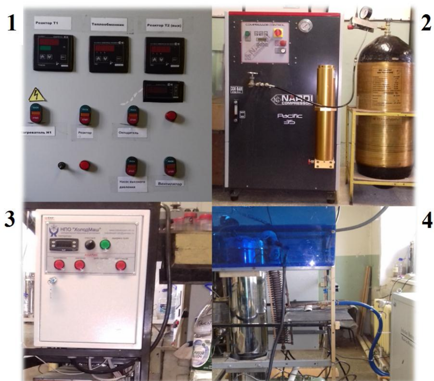
Рисунок 3 – Мобильная установка проточного типа для реализации процесса СКВО уровня TRL 5: 1 - пульт управления; 2 – компрессор воздушный; 3 – охладитель; 4 - реактор с индукционным нагревом.
