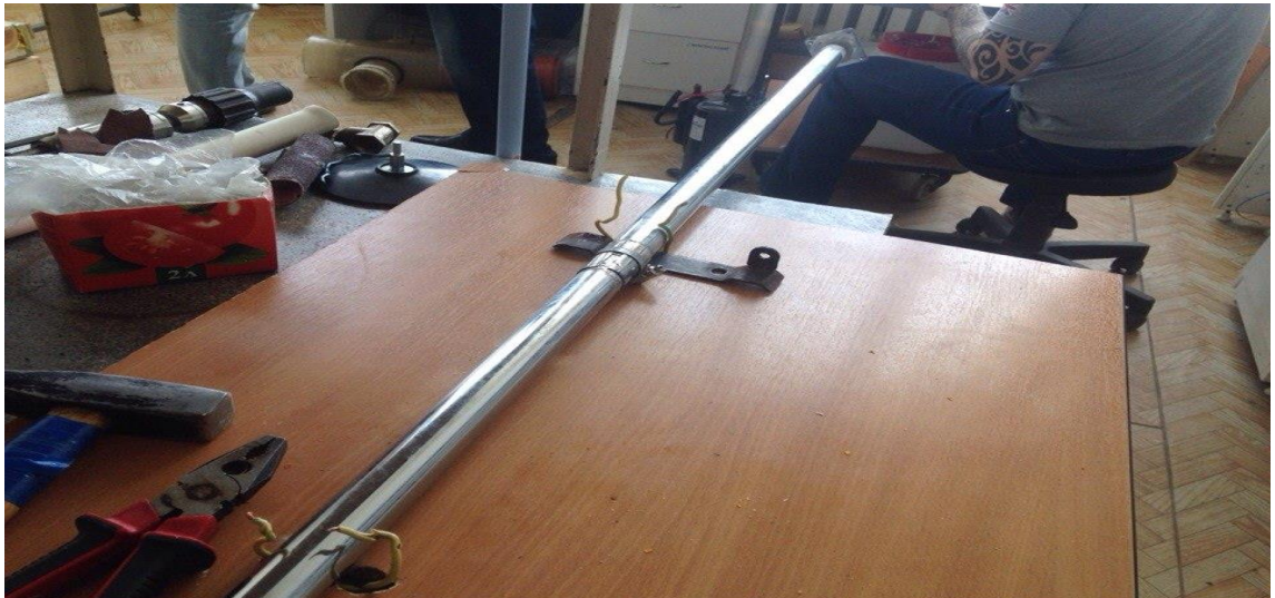
Рис. 1.1 Сборка рабочей часть стенда из стальных труб
