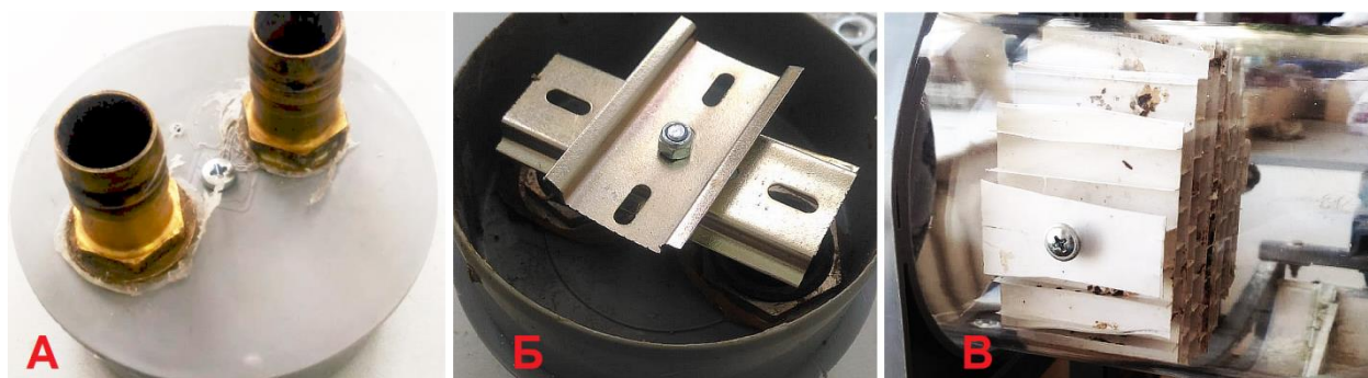
Рис. 1.12. Конструкция торцевого входа для подачи воды и газа
