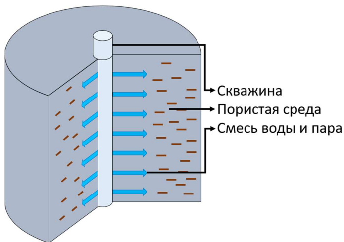
Рисунок 3.1. Схематичное изображение процесса вытеснения нефти смесью воды и пара в разрезе скважины
