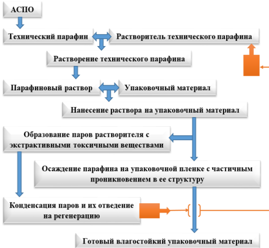
Рисунок 11. Технологическая схема получения гидрофобной пленочной структуры
