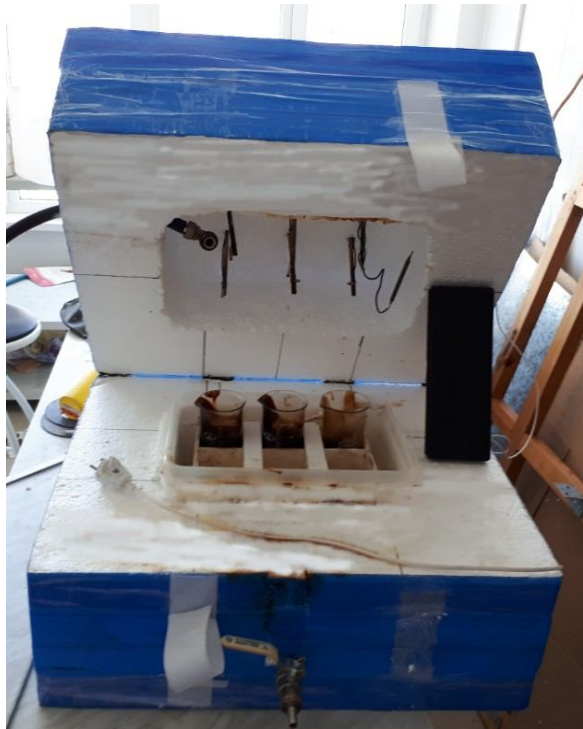
Рисунок 2.2.6 – Устройство для определения скорости осаждения АСПО в открытом виде
