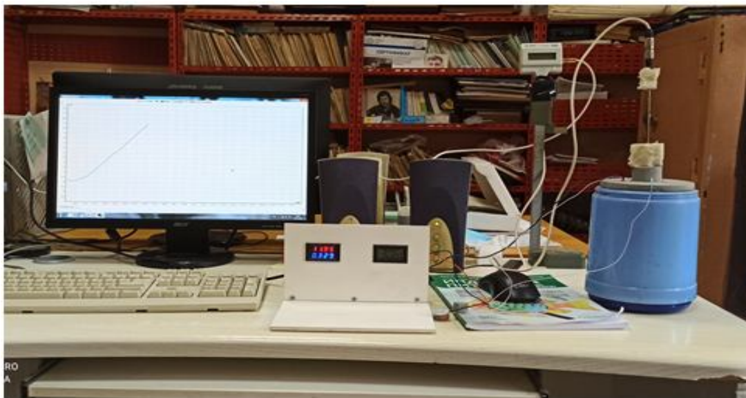
Рисунок 3.2.4 – Экспериментальная установка для определения теплоемкости жидких материалов
