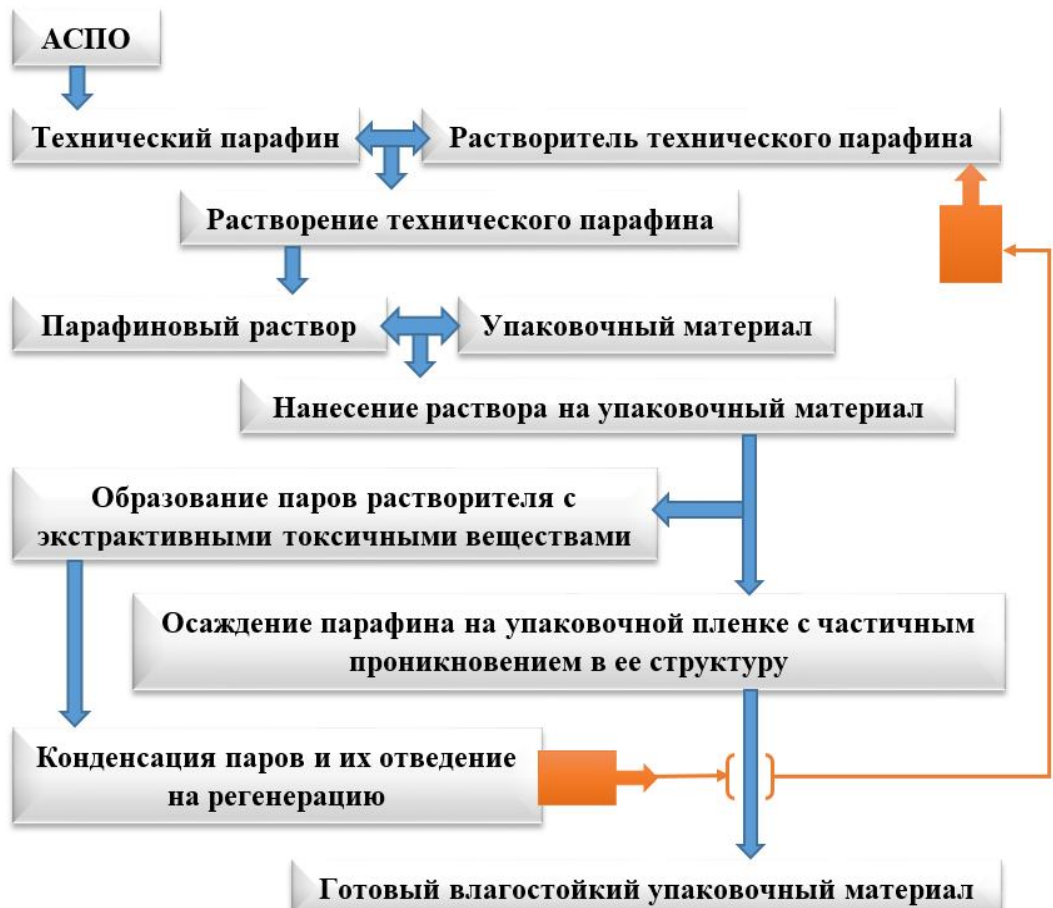
Рисунок 3.1.1 – Технологическая схема получения гидрофобной пленочной структуры
