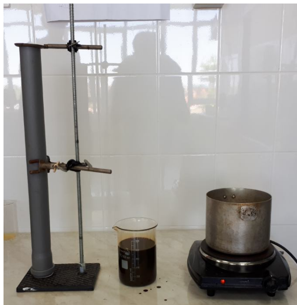
Рисунок 2.2.7 – Опытный стенд по определению плотности нефти и АСПВ
