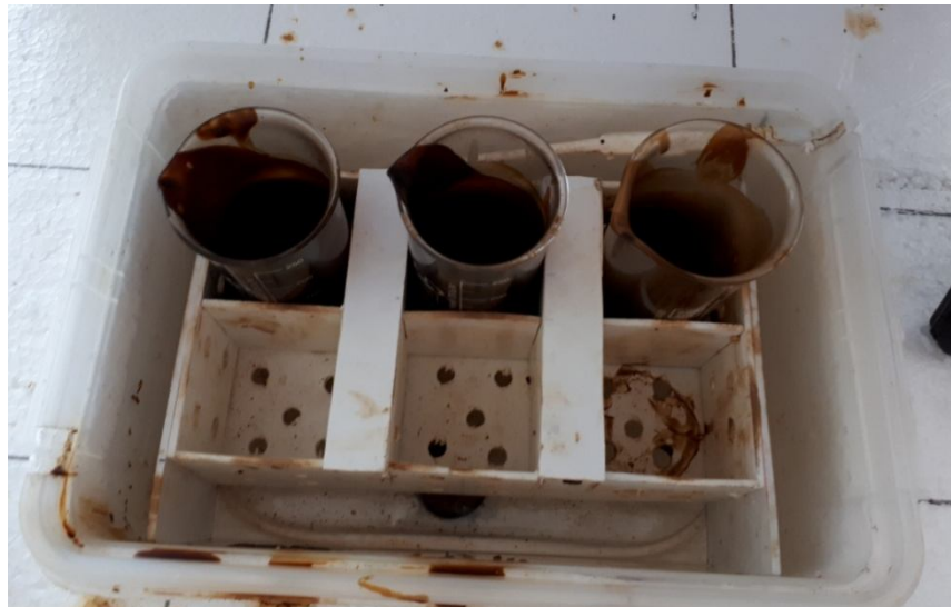
Рисунок 2.2.5 – Короб с перфорациями и опытными образцами АСПО
