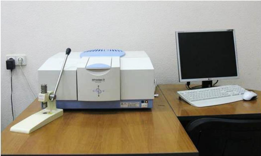
Рисунок 5. Спектрофотометр ИК-Фурье IRPrestige-21
