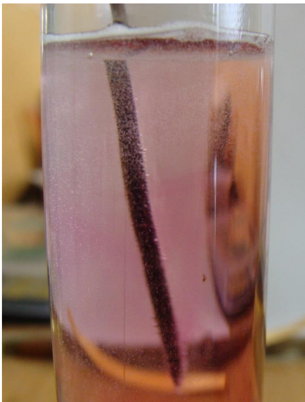
Рис. 5.18. Процесс выделения водорода на катоде, погруженном в раствор электролита \text{KMnO}_4 конц. 0.5 ммоль/л
