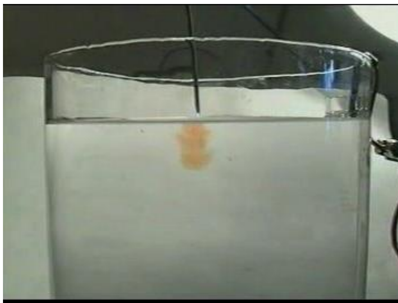
Рис. 4.2 Визуализация потоков в растворе при зажигании тлеющего разряда (первые секунды с момента зажигания) на примере раствора \text{MnCl}_2 в качестве катода (ток разряда 25 мА) [372].
