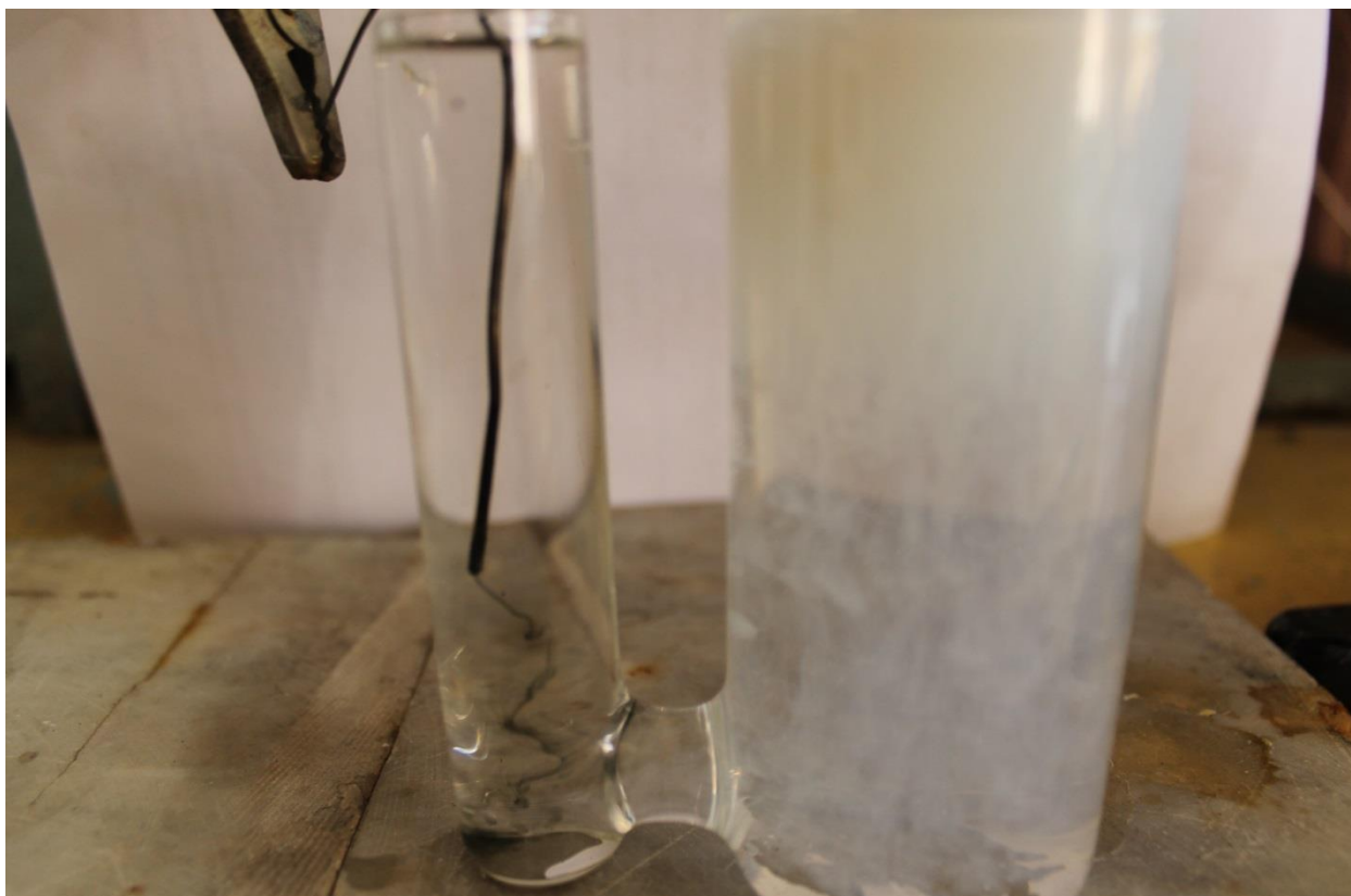
Рис. 5.20. Процессы окисления на погруженном аноде при действии тлеющего разряда. Материал электродов – молибден, ток разряда 20 мА, дистиллированная вода
