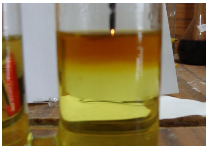
Рис. 5.4. Окисление ферроцианида при воздействии тлеющего разряда ( I=20 мА). 1 мМ K_4[Fe(CN)_6]
