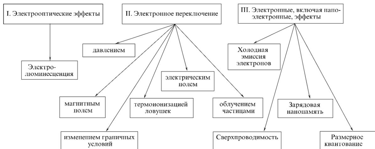
Рис. 2.2. Систематика электронных эффектов, наблюдающихся в полимерах с несопряженной системой  $\pi$ -электронов.
