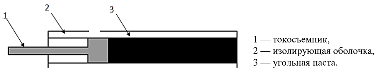
Рисунок 2.1. Схема угольно-пастового электрода
