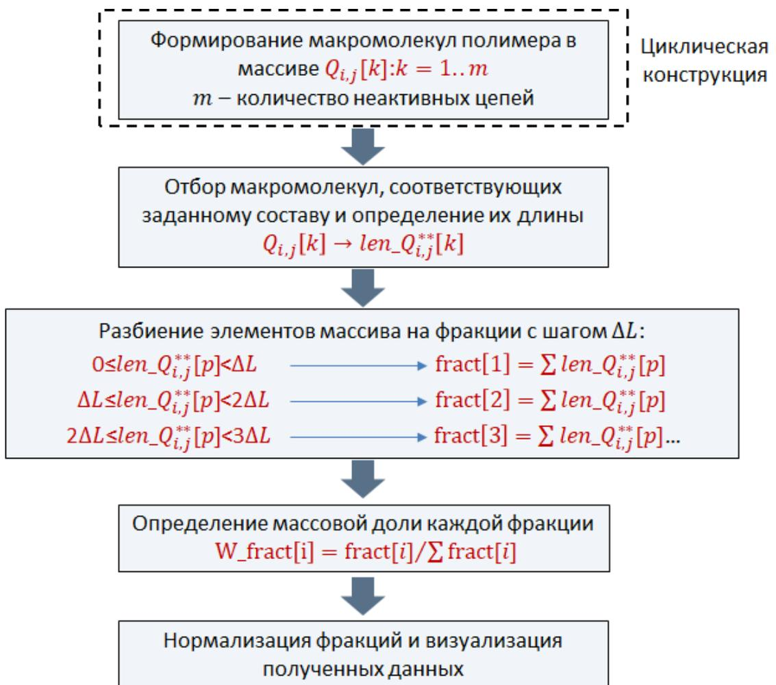
Рис. 3.6. Алгоритм программного фракционирования макромолекул с целью оценки размер-состав распределения
