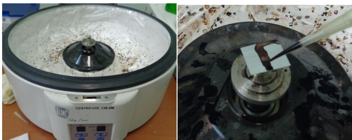
Рисунок 22. (а) Центрифуга CM-6M и (б) образец до вращения подложки с добавлением раствора полимера
