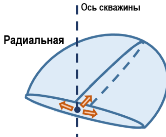
Рис. 1.2. Радиальный рост трещины из источника (синяя точка)
