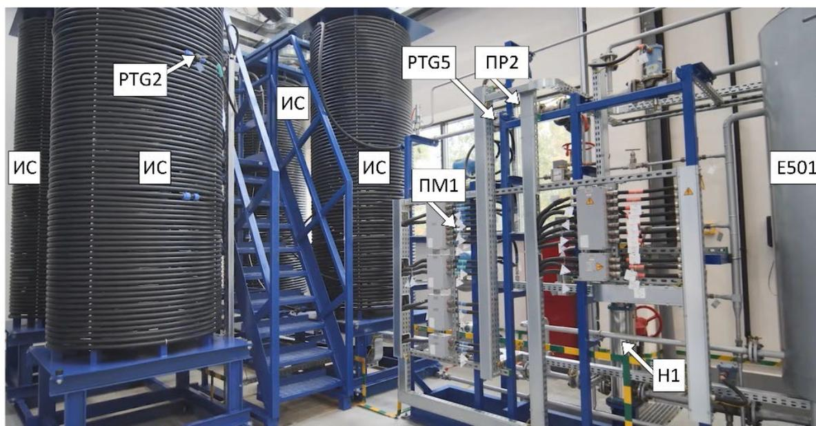
Рис. 7. Общий вид блока нестационарных процессов (501 — емкость 1 000 л; Н1 — циркуляционный центробежный насос; РР1 — регулятор расхода; ИС — исследовательская секция, длиной 1 139 м; РТГ1, РТГ2, РТГ5 — преобразователи давления; РР1, РР2 — преобразователи расхода; ПМ1 — массовый расходомер; ЭМ1 — электромагнитный клапан.)
