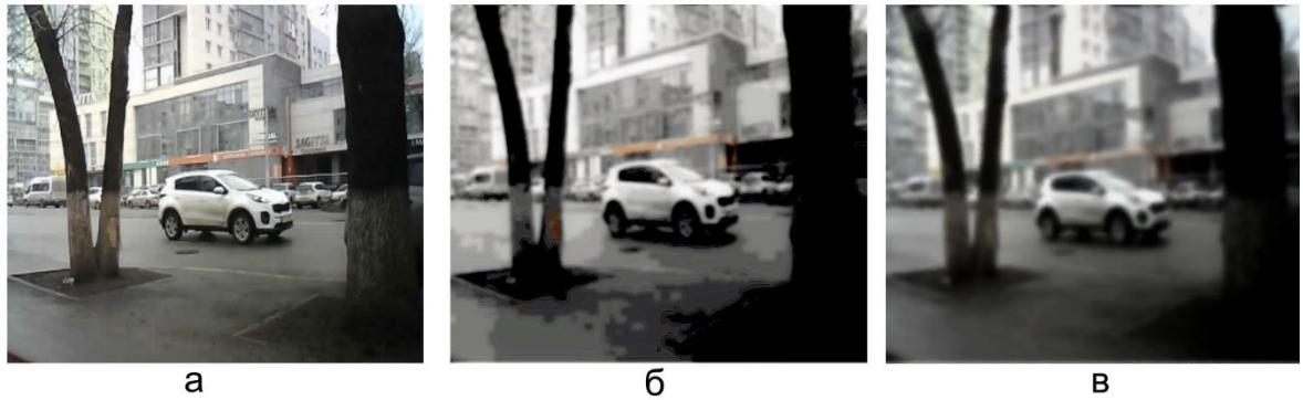
Рисунок 4.4.3 – Обработка изображения КДП: (а) исходное изображение, (б) изображение после обработки кодеком, (в) восстановленное изображение с использованием гауссового фильтра нижних частот.
