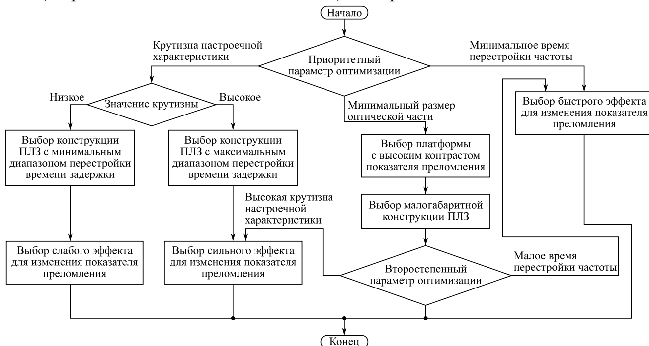
Рисунок 5 – Схема методики структурной оптимизации оптической части петли обратной связи ОЭО
