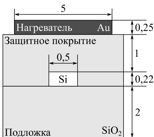
Рисунок 3.11 – Сечение волновода с нагревательным элементом. Все размеры указаны в мкм
