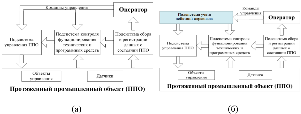
Рисунок 4.24 - Структурные схемы базовой (а) и модифицированной (б) подсистем операторского управления технологическим процессом
