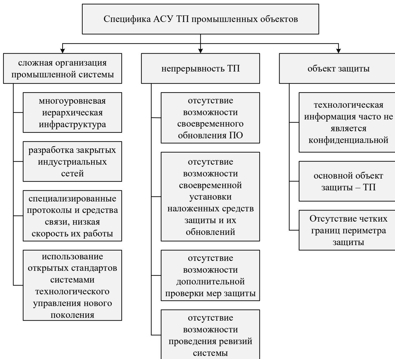
Рисунок 1.4 – Особенности АСУ ТП, затрудняющие обеспечение ИБ промышленных систем
