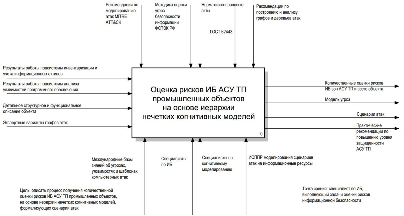
Рисунок 2.1 – Функциональная модель процесса оценки рисков ИБ АСУ ТП промышленных объектов
