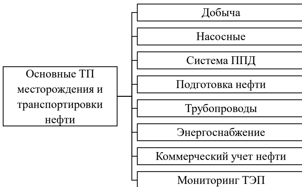
Рисунок 4.21 – Основные ТП системы обустройства месторождения и ТТН (ППД – поддержание пластового давления; ТЭП – технико-экономические показатели)
