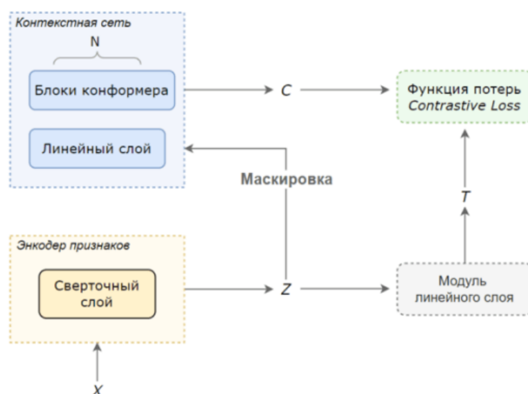
Рисунок 4.14 – Схема обучения нейронной сети Wav2vec для модели биометрической аутентификации по голосу
