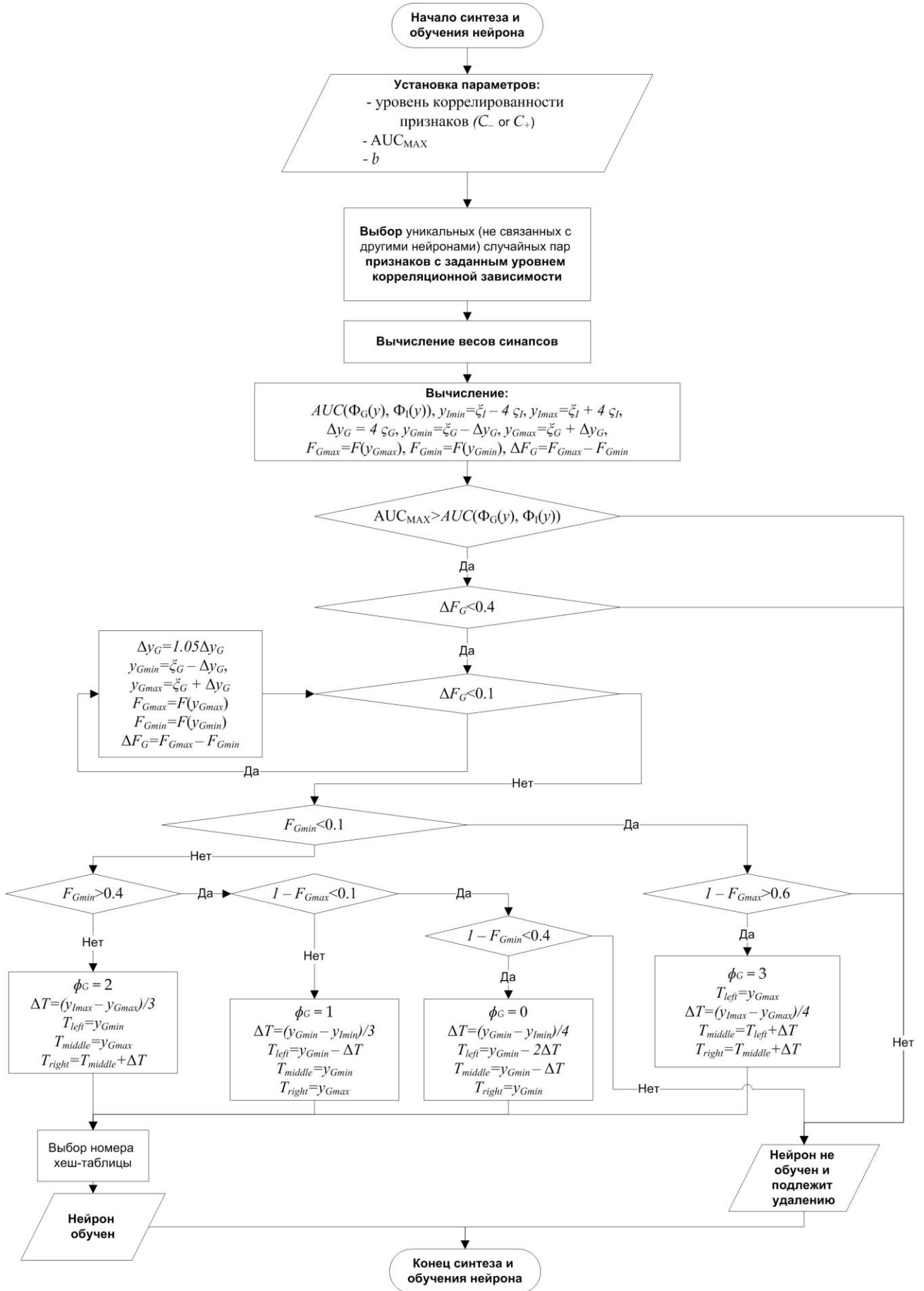
Рисунок 2.16 – Схема алгоритма синтеза и обучения корреляционного нейрона
