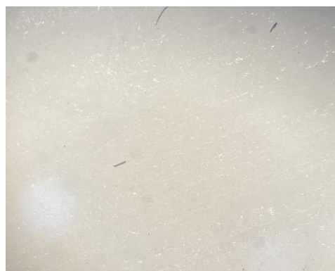
Рис. 107. Увеличенное изображение поверхности изделия, выполненного путем струйной печати
