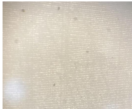
Рис. 109. Увеличенное изображение поверхности изделия, выполненного путем стереолитографии
