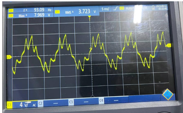
Рисунок 105 – Осциллограмма фазного тока одного из модулей
