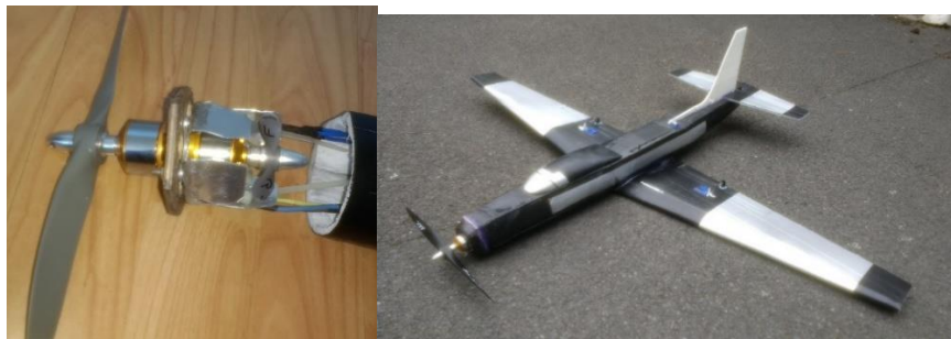
Рисунок 11 – Радиоуправляемый самолет с использованием двух ЭД воздушного винта
