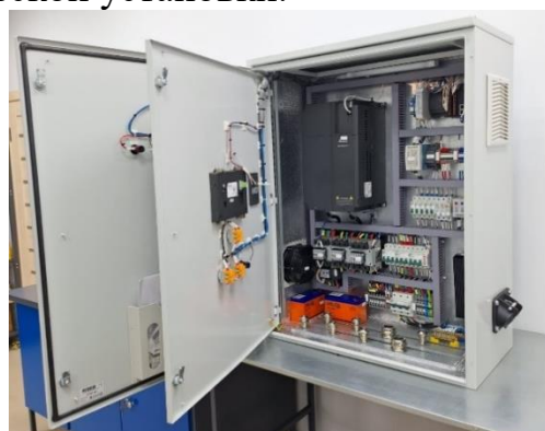
Рисунок 10 – Внешний вид интеллектуальной станции управления электроприводом УШГН (патент № 229611)
