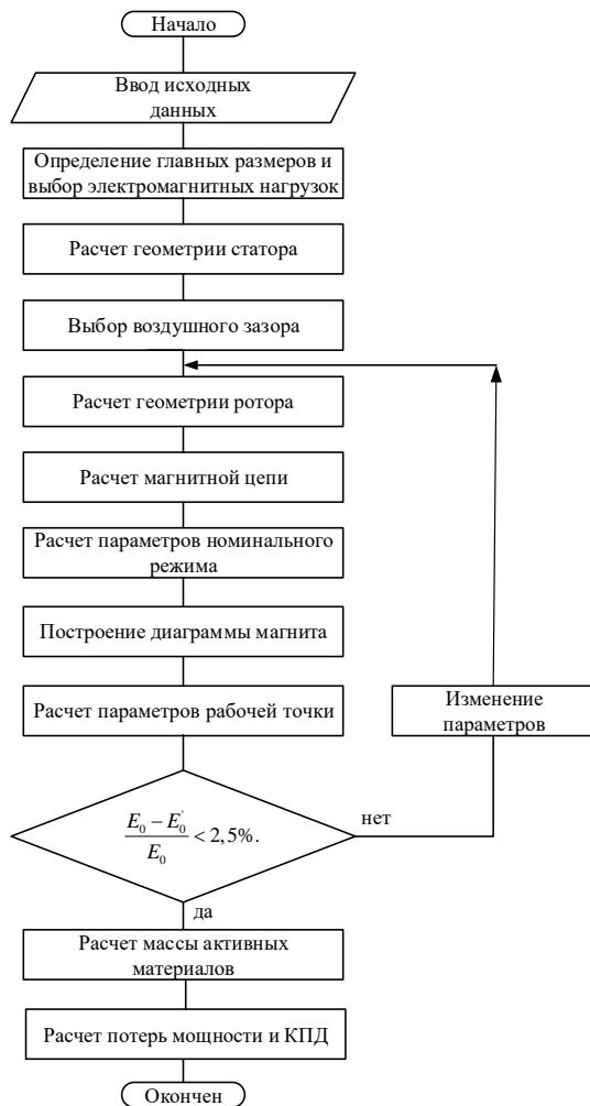
Рисунок 6 – Блок-схема алгоритма проектирования электроприводов УШГН на базе вентильного электропривода
