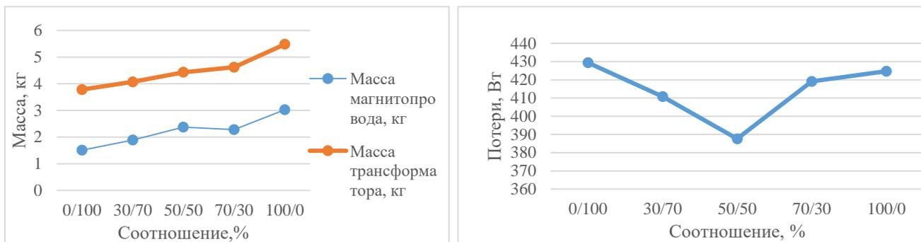
Рисунок 4-1 Зависимость полной массы трансформатора и его магнитной системы (слева) и полных потерь в трансформаторе (справа) при разных соотношениях материалов в магнитной системе
