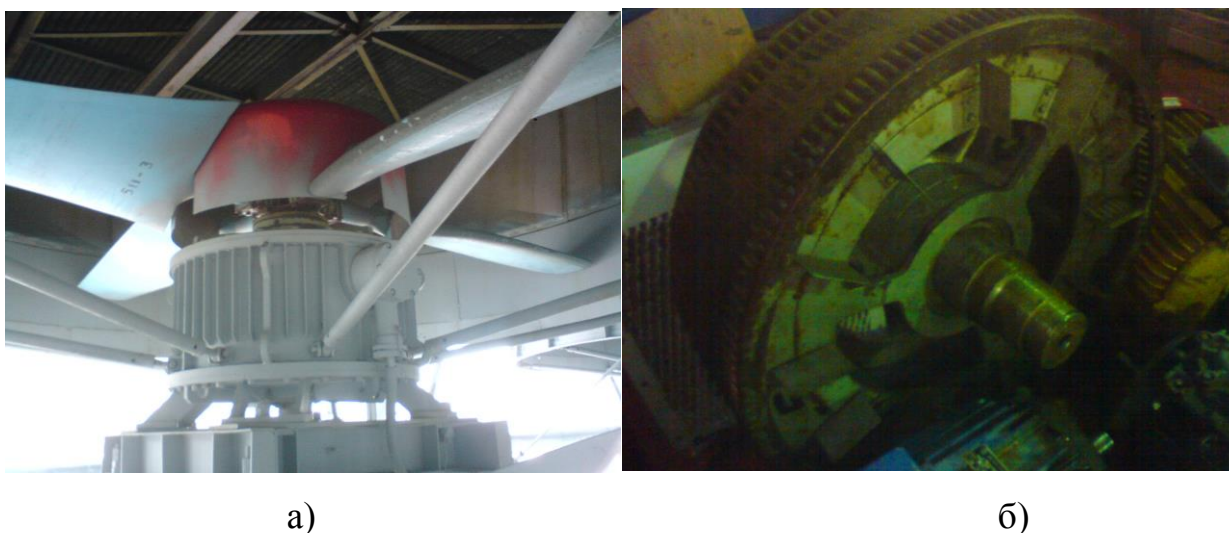
Рисунок 1.2 – Электродвигатель ВАСО16-14: а) внешний вид на станине с колесом ГАЦ-50; б) ротор.
