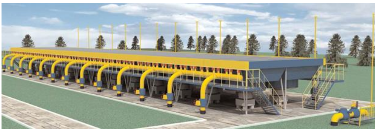
Рисунок 1.4 – Степень охлаждения установки АВО газа
