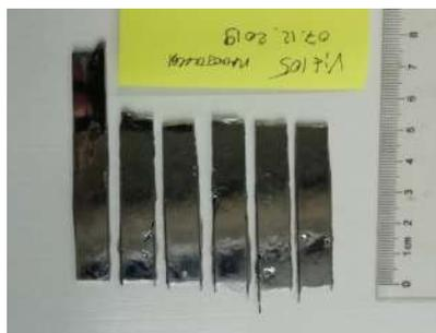
Рисунок 2.2 — Общий вид исходных образцов объёмного металлического стекла. Пластины ОМС Vit105, предоставлены проф. Дж. Т. Ванг, Нанкинский университет, Китай; толщина 2 мм, длина ок. 50 мм.
