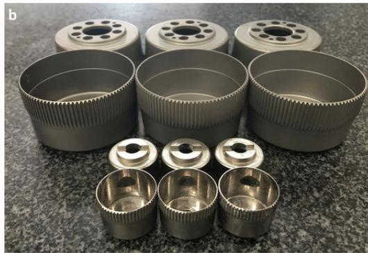
Рисунок 1.22 — Высокоточные отливки гибких шестерён для волновых передач [132].
