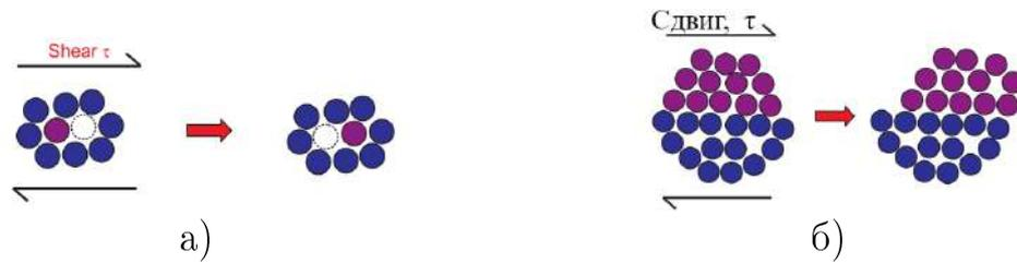
Рисунок 1.8 — Двумерные схематические диаграммы механизмов атомистической деформации, предложенных для аморфных металлов, включая индивидуальный атомный скачок (макроскопическая диффузия и поток) (а, *Spraeren*, 1977) и зона сдвигового преобразования (спонтанная и кооперативная реорганизация) (б, *Argon*, 1979). Илл. приводятся по [21].
