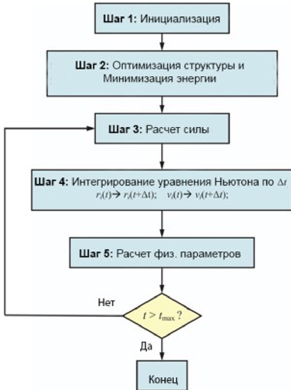
Рисунок 1.10 — Блок-схема процесса моделирования с использованием метода МД [92].
