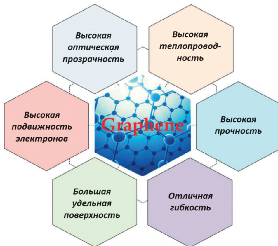
Рисунок 1.7 — Свойства графена – монослоя атомов углерода [84].
