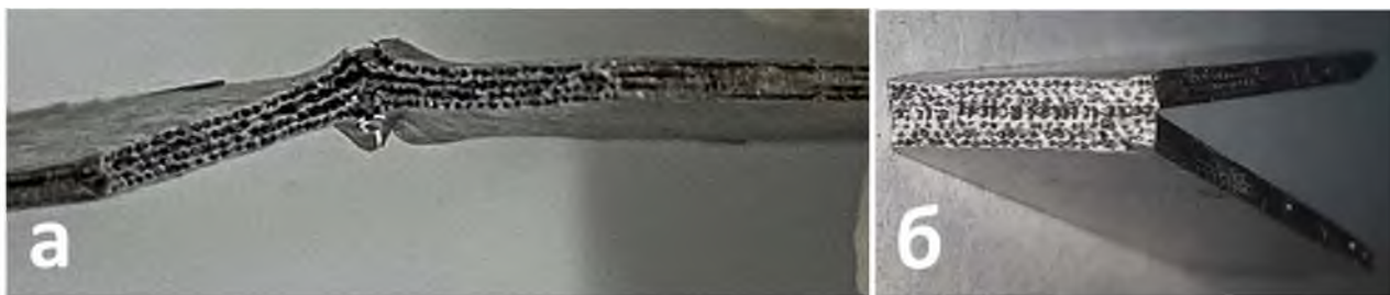
Рисунок 5.17 – Вид разрушенного образца после испытаний на трехточечный изгиб при комнатной температуре (а) вид разрушенного образца после динамического удара при комнатной температуре (б) [93]
