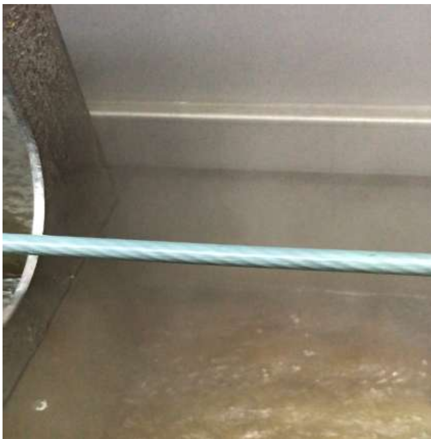
Рисунок 4.9 - Строительный канат из композитного материала «Полипропилен-УНТ»
