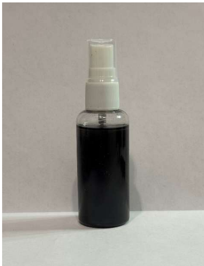
Рисунок. 4.14 - Адгезив на основе поливинилпирролидона с содержанием УНТ 0,12%масс.
