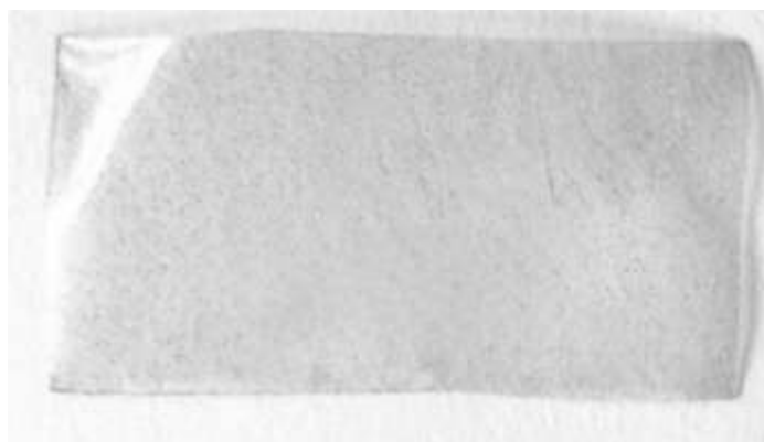
Рисунок 4.12 - Полимерная пленка на основе поливинилового спирта и УНТ
