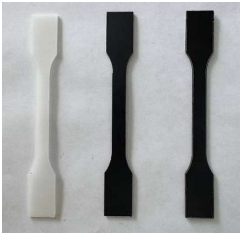
Рисунок 5.12 - Образцы из полипропилена с различным процентным содержанием УНТ
