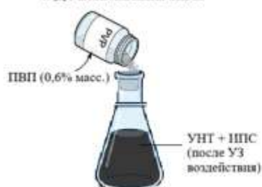
Рисунок 4.13 - Схема поэтапного получения адгезива на основе УНТ
