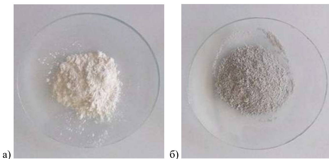
Рисунок 4.2 - Порошкообразный ПММА до процесса полимеризации: а) без УНТ; б) с УНТ 0,05 мас.%
