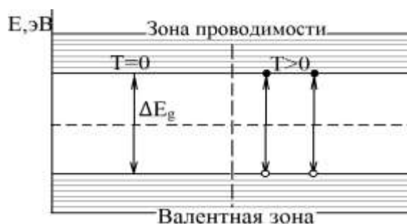
Рисунок 5.7 - Схематичное изображение ширины запрещенной зоны и процессов, происходящих при увеличении температуры
