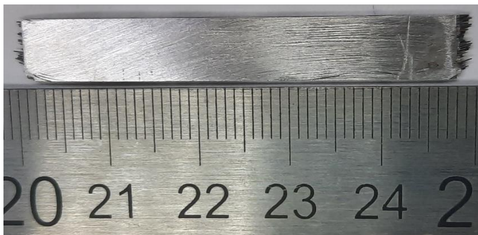
Рисунок 2.5 – Образец для испытаний на трехточечный изгиб
