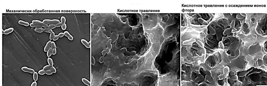
Рисунок 1.9 – Снимки сканирующего электронного микроскопа поверхностей с поэтапной обработкой, показывающее уменьшение количества бактерий на поверхности с осажденными ионами фтора [106]
