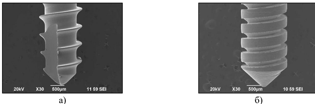
Рисунок 5.8 – Внешний вид винтов, полученный в РЭМ: а) – наноструктурные винты; б) – винты фирмы ООО «Конмет»
