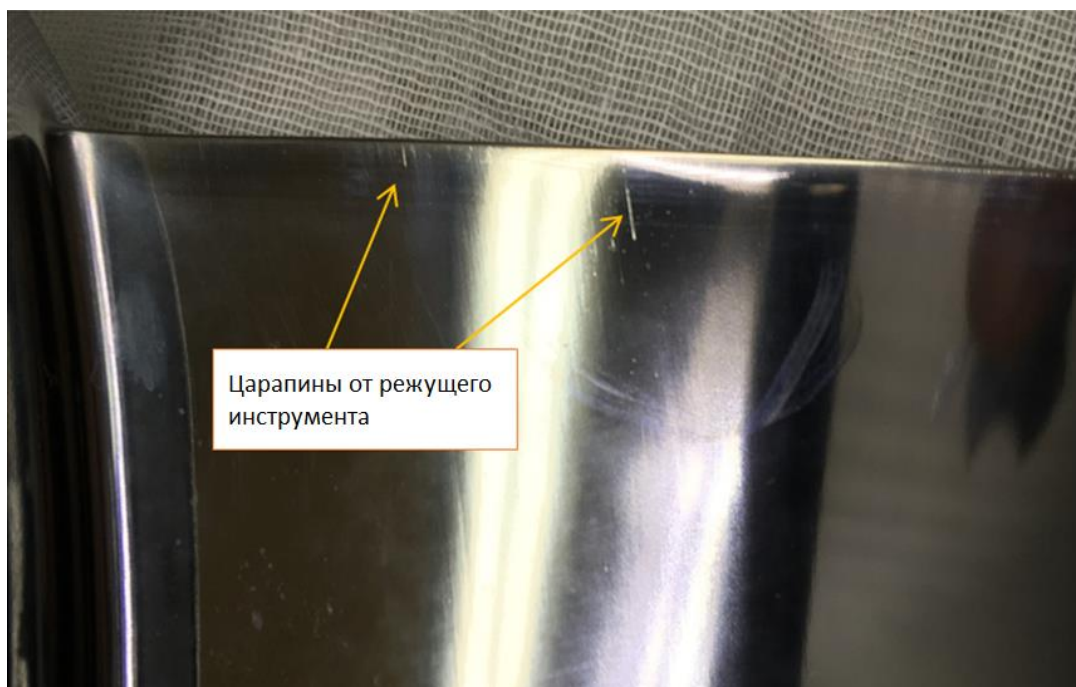
Рисунок 71 – Царапины от режущего инструмента, выявленные на лопатках НА из сплава ВТ6 после 1 минуты ЭПП
