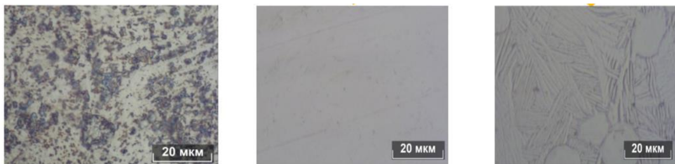
Рисунок 27 – Состояние поверхности после 1 мин ЭПП в растворе \text{NH}_4\text{F} - 7,4 г/л, \text{KCl} - 30 г/л с добавкой \text{HCl} : а) 0 мл; б) 1 мл; в) 2 мл
