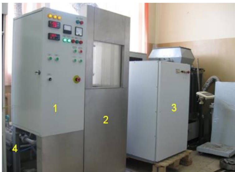
Рисунок 15 – Внешний вид опытно-экспериментальной установки ЕРР-50ЕМ: 1 - пульт управления, 2 - рабочий модуль, 3 - источник питания, 4 - емкость для хранения и нагрева электролита
