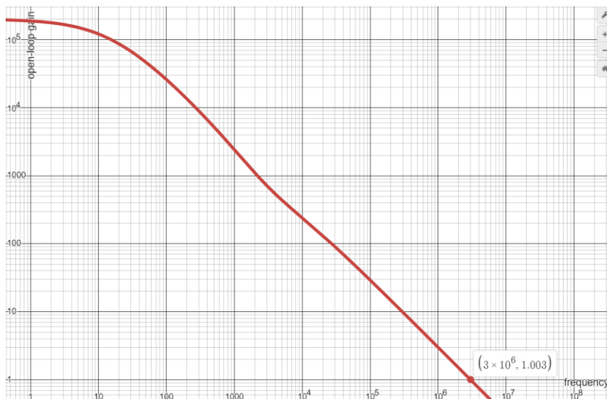
Рис. 2. График зависимости коэффициента усиления для разомкнутой петли отрицательной обратной связи от частоты входного сигнала для разработанного усилителя
