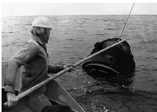
Рис. 3. А – Спускаемый аппарат станции «Зонд-5» швартуют к шлюпке НИС «Боровичи»; Б – Вид станции «Зонд-5» (спускаемый аппарат и приборно-агрегатный отсек)
