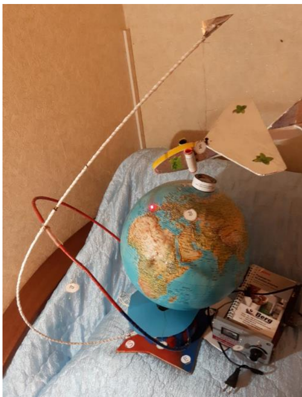
Рис. 1. Имитатор внешнего для СБПЛА поля и пролета СБПЛА над Землей
