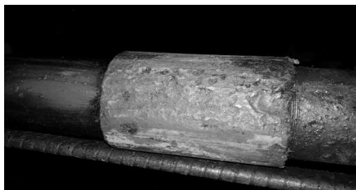
Рисунок 1. Сероводородная коррозия НКТ
