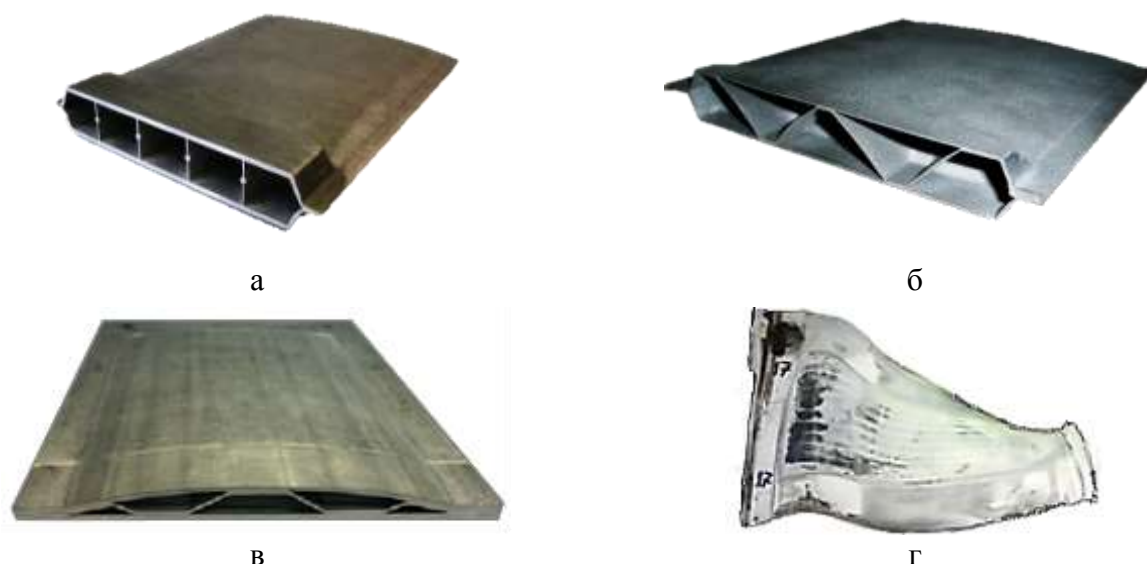
Рис. 1. Полые многослойные конструкции, полученные в условиях низкотемпературной сверхпластичности (а - образец четырехслойной ячеистой конструкции, б - образец трехслойной гофрированной конструкции, в - плоский образец полый лопатки, г - опытная полая широкохордная рабочая лопатка вентилятора двигателя ПД-14).
