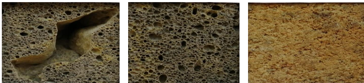
Рис. 1. Структура наноструктурированной пенокерамики.
