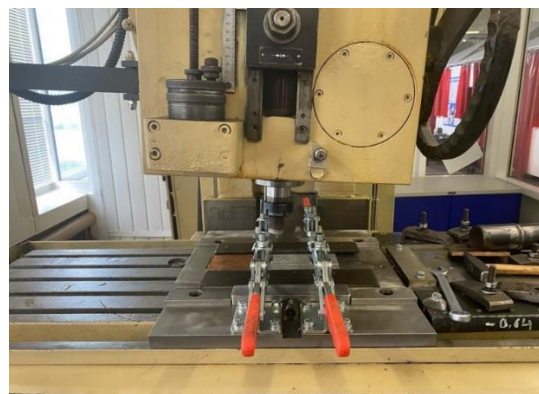
Рис. 6 – Плита оснастки с установленными датчиками и заготовками
