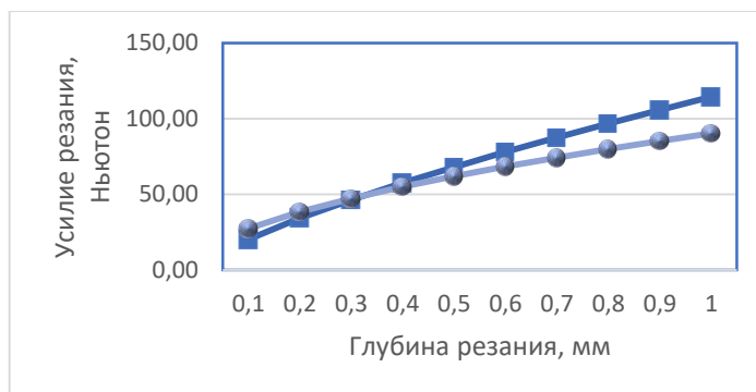
Рис. № 3 – График зависимости сил резания, действующих на прогиб детали от глубины резания слоя металла: □ – строгание ○ – фрезерование
