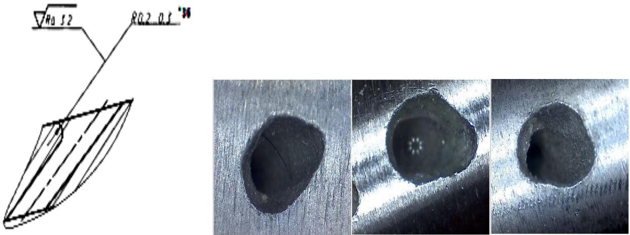
Рис. 1. Геометрия и вид фактического скругления кромок отверстий лопаток турбин
