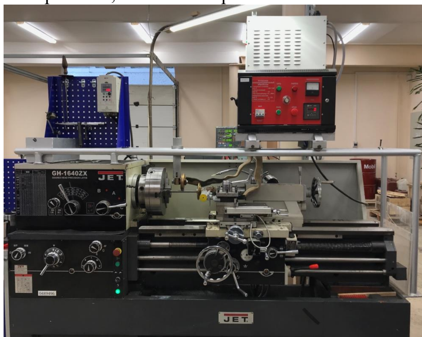
Рис. 2. Использование ЭМО для упрочнения наружной цилиндрической поверхности ответственных деталей
