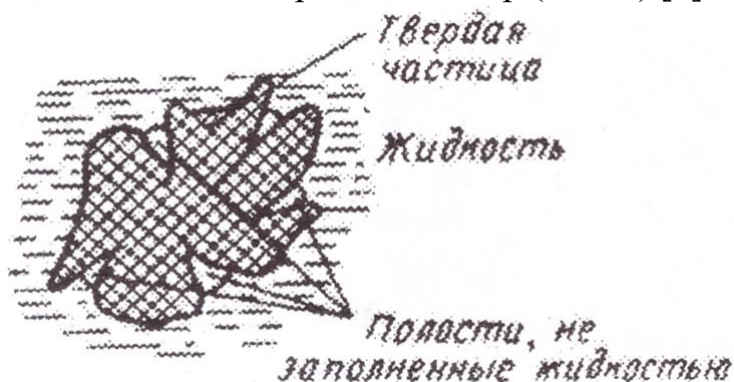
Рис. 1 – Схема образования зародышей газовых пор на частицах, не смачиваемых жидкостью [3].
