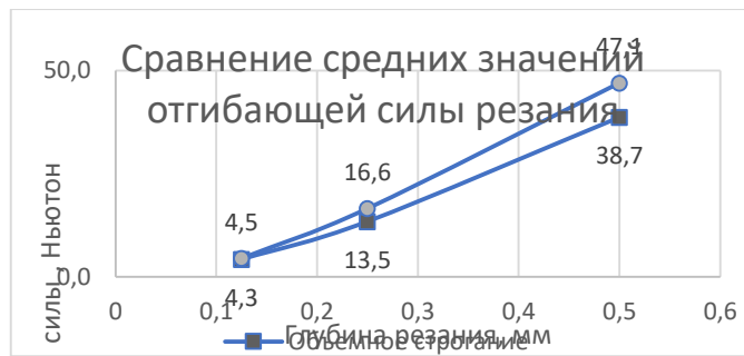
Рис. № 8 – График зависимости прогибающей силы резания от глубины резания при одинаковой подаче на зуб ( S_z=0,3 мм/зуб): □ – строгание ○ – фрезерование
