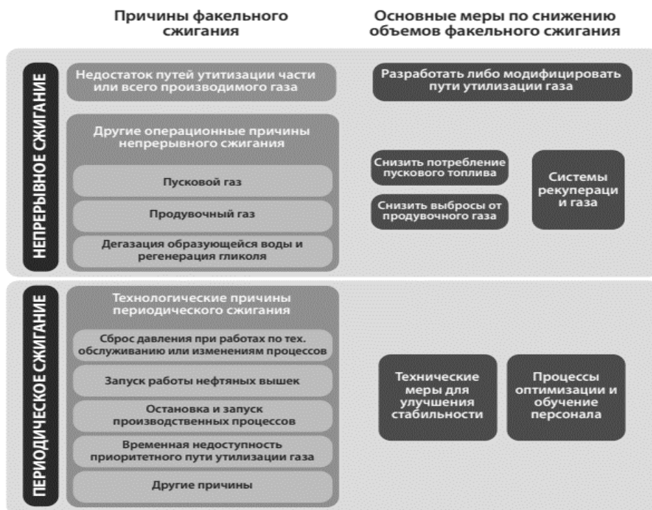
Рис. 2. Рассмотрение типов факельного сжигания газа и соответствующих мероприятий по уменьшению объемов сжигания
