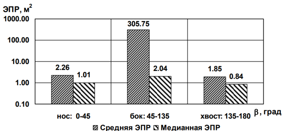
Рис. 3. Диаграммы средней и медианной ЭПР Ту-22М3 в трех диапазонах азимутальных углов при зондировании на горизонтальной поляризации и частоте 10 ГГц (длина волны 3 см)
