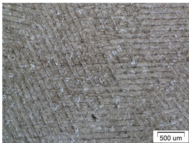
Рис. 4. Поры различных размеров сплава Инконель 718 (после ГИП) (оптическая микроскопия)
