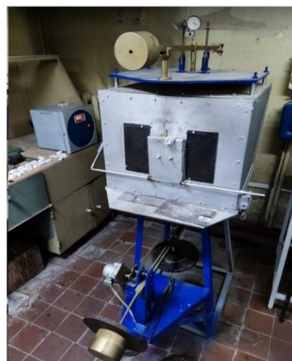
Рис. 2. Установка для исследования термомеханических свойств оболочковых форм, включает в себя: 1 – рычаг верхний; 2 – система нагружения; 3 – высокотемпературная печь; 4 – подставка; 5, 6 – кронштейны; 7 – керамические упоры; 8 – жаропрочный клин нагружения; 9, 10 – система фиксации верхней плиты; 11, 12 – система фиксации деформация образца; 13, 14, 15, 16, 17 – система записи нагрузки и деформации образца; 18 – измеритель; 19 – платинородиевая термопара.
