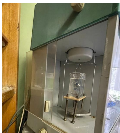
Рис. 5. Взвешивание образцов на аналитических весах ВЛ7-200: а – на воздухе; б – в жидкости
