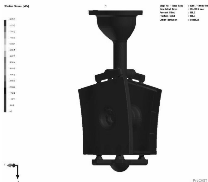
Рис. 3. Места образования горячих трещин в отливке
