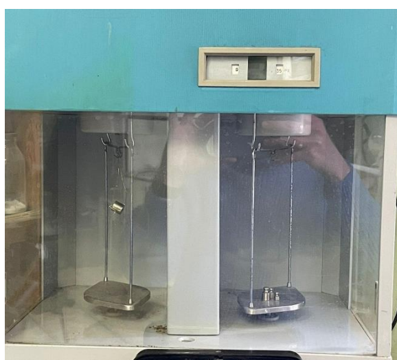
Рис. 5. Взвешивание образцов на аналитических весах ВЛ7-200: а – на воздухе; б – в жидкости
