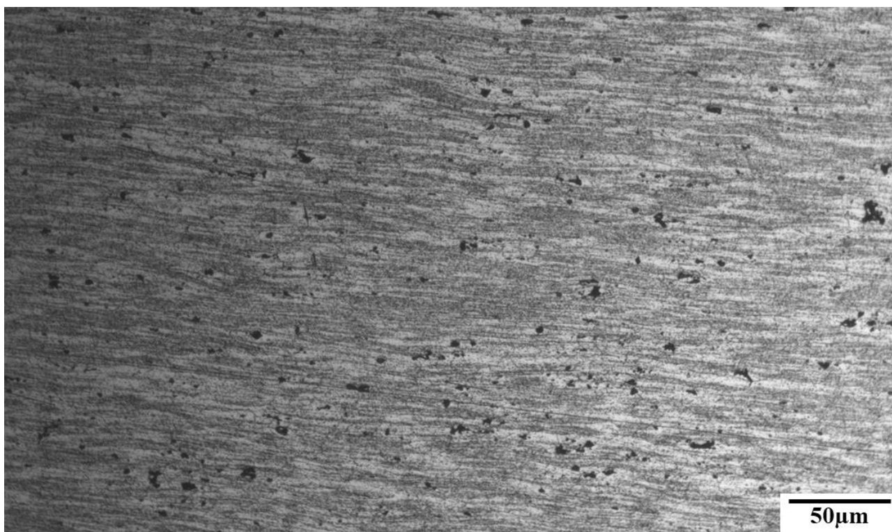
Рис. 1. Микроструктура сплава 1565 после прокатки (исходное состояние)
