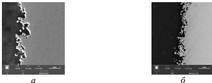
Рис. 2. Металлография поперечного сечения проволоки сплава Al-0,5Fe, покрытого медью:
