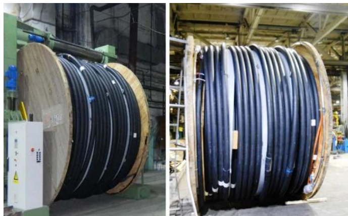
Рис. 5. ВТСП кабель в криостате на транспортной катушке [18]
