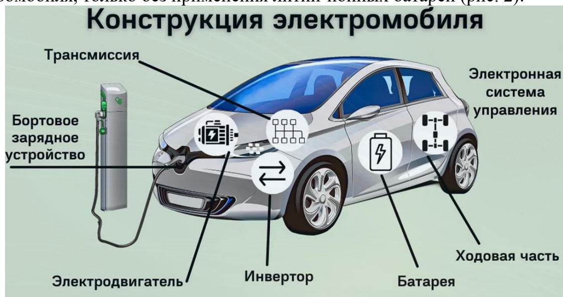
Рис. 2. Конструкция обычного электромобиля
