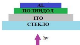
Рис. 1. Структура фоторезистора с пленкой производного полианилина
