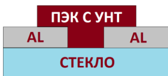
Рис. 1. Структура тонкопленочного резистивного датчика
