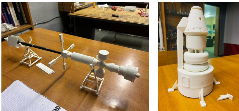
Рис. 2. Макеты МТК и ВПК, изготовленные методом 3D-печати
