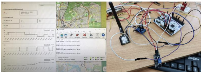
Рис. 1. Отображение данных с датчиков в Righttech.io и макет устройства
