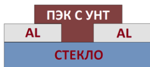
Рис. 1. Структура тонкопленочного резистивного датчика
