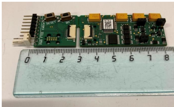
Рисунок 3. Интегральный цифровой контроллер сенсора метана.
