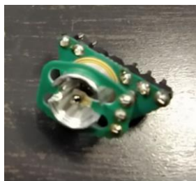
Рисунок 2. Левое окно – излучатель и приемник оптической ячейки. Правое окно – реализация оптической ячейки (длина ячейки – 40 мм).
