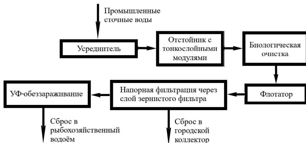
Рис. 1. Блок-схема очистки сточных вод
