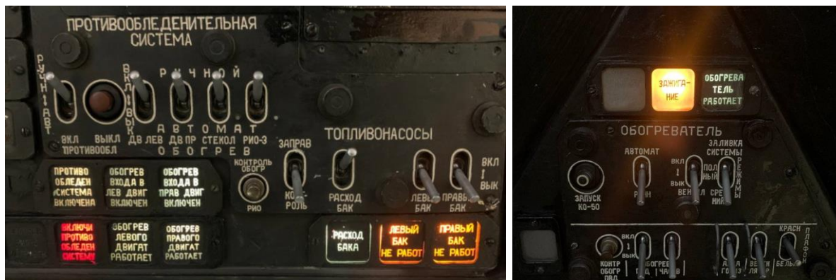
Рис. 3. Противообледенительная система, топливонасосы и керосиновый обогреватель КО-50
