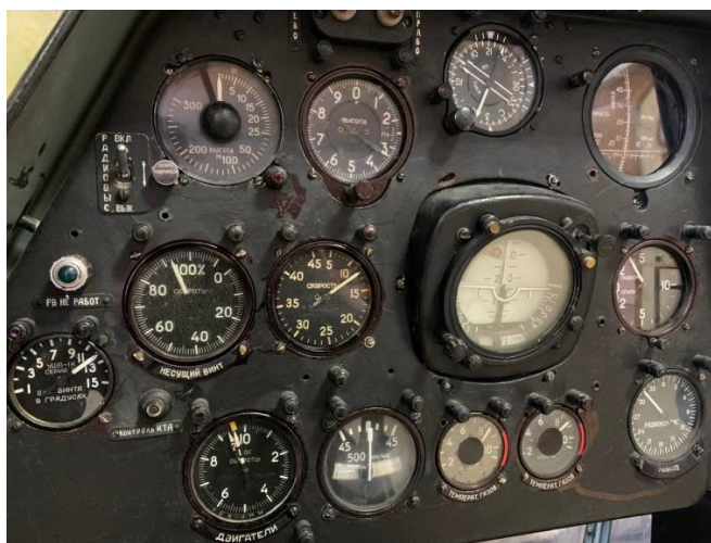
Рис. 7. Левая приборная доска КВС в режиме набора высоты
