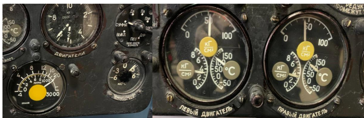
Рис. 6. Топливомер и трехстрелочные указатели параметров двигателей
