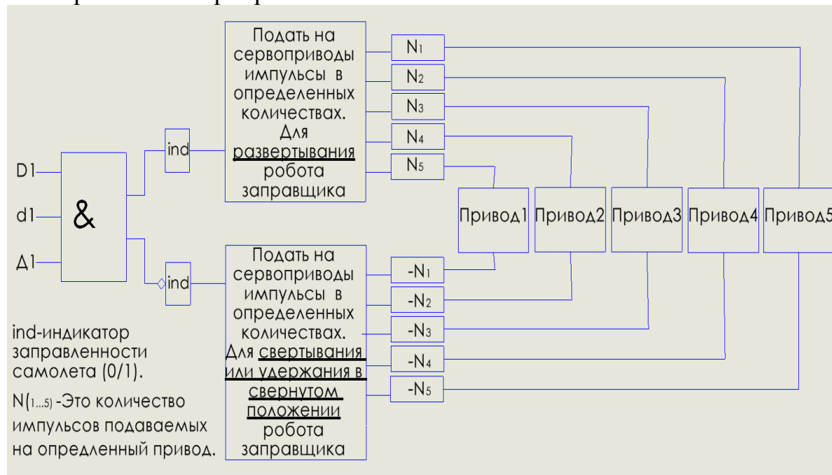
Рис. 6. Типовой алгоритм управления процессом заправки ВС
