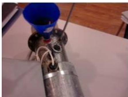
Рис. 2. Измерение плотности теплового потока с неизолированной поверхностью трубы
