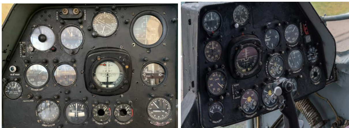
Рис. 5. Приборная доска командира воздушного судна (КВС) и правого летчика-штурмана
