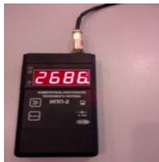
Рис. 2. Измерение плотности теплового потока с неизолированной поверхностью трубы
