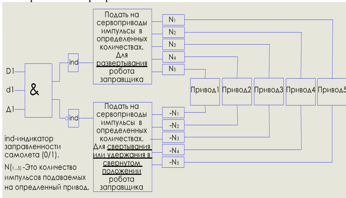
Рис. 6. Типовой алгоритм управления процессом заправки ВС
