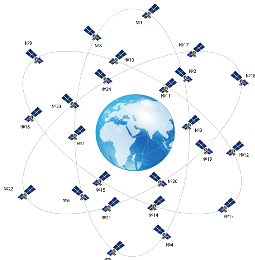
Рис. 1. Расположение спутников ГЛОНАСС вокруг земной орбиты
