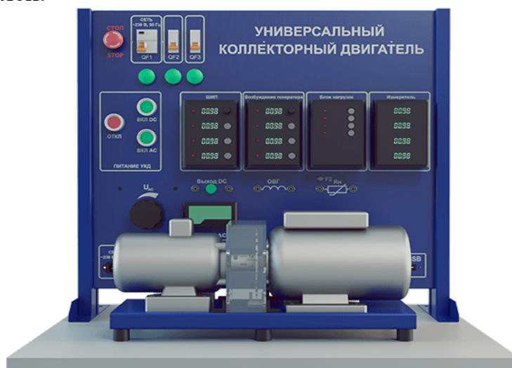
Рис. 1. Внешний вид стенда, содержащий коллекторный двигатель постоянного тока
