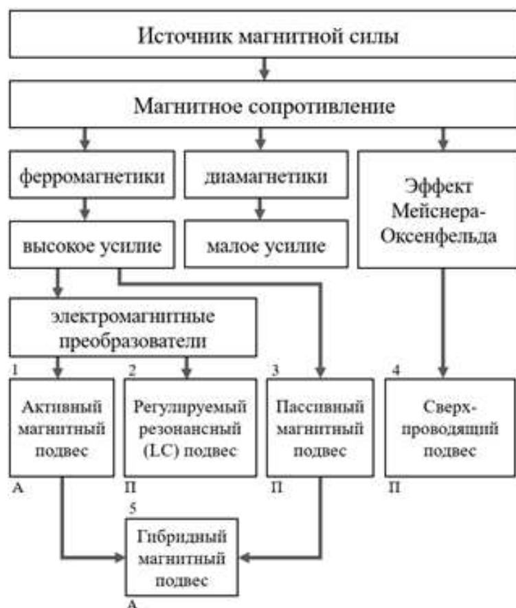
Рис. 1. Классификация магнитных подвесов
