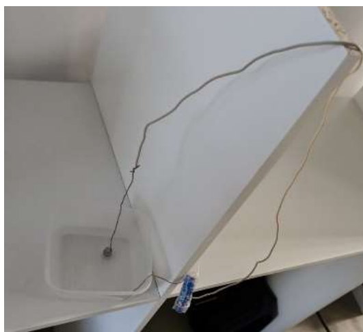
Рис. 6. Модель электрического двигателя Фарадея
