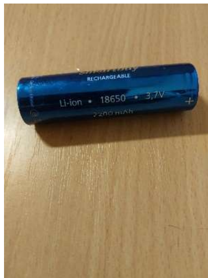
Рис. 4. Аккумуляторная батарея 3,7 В
