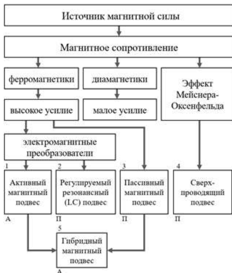
Рис. 1. Классификация магнитных подвесов
