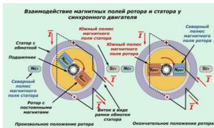
Рис. 2. Схема работы синхронного двигателя
