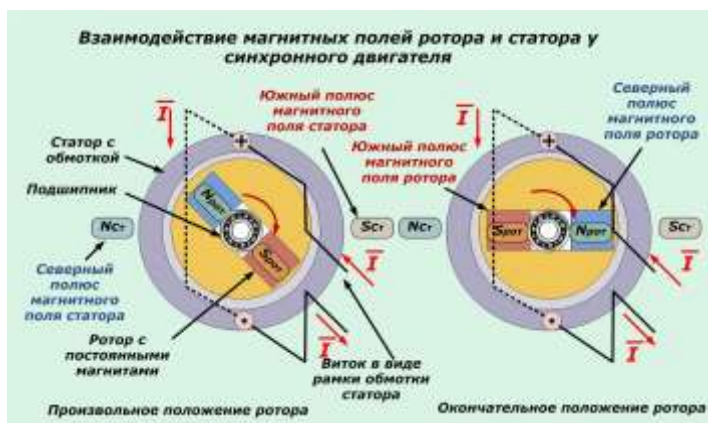
Рис. 2. Схема работы синхронного двигателя
